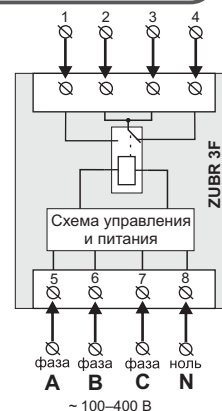
Схема 1. Упрощенная внутренняя схема и схема подключения.
