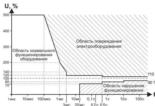
Рис. 1. Кривая работы электрооборудования ITIC (CBEMA), ( http://www.home.agilent.com/upload/cm_upload/All/1.pdf?&cc=UA&lc=eng ).
