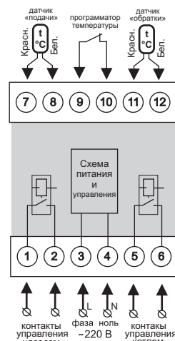
Схема 1. Упрощенная внутренняя схема и схема подключения
